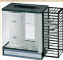
Cet appareil s'appelle un **thermohygrographe** ou **thermohygromètre**.
